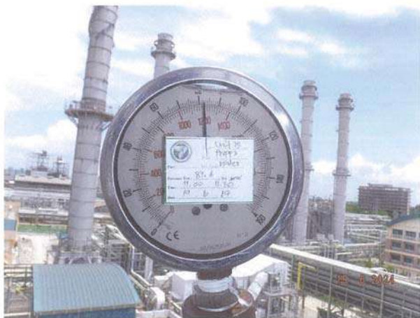
ภาพถ่ายแสดงขณะทำการทดสอบความดันใน การตรวจทดสอบหม้อน้ำ
