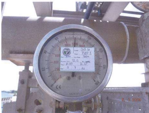
ภาพถ่ายแสดงขณะทำการทดสอบความดันใน การตรวจสอบหม้อน้ำ
